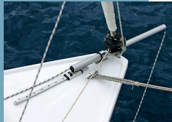
Extra: verschiebbarer Gennaker-Rüssel. Einen Bugkorb wie früher gibt es nicht
