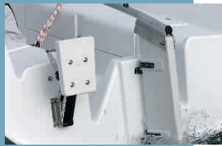
Extra: Motorhalterung zum Hochziehen
